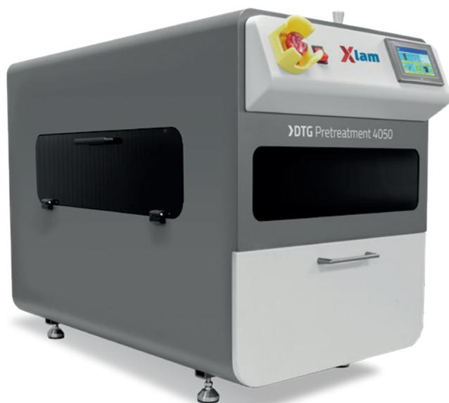
Macchina per il pre-trattamento di t-shirt e altri tessuti Direct to Garment (DTG). Come nuova, usata solo in sala demo. Area di lavoro 40x50cm, ugello nebulizzatore ad alta pressione, sistema di controllo PLC touch screen, taniche per i liquidi incorporate, veloce e affidabile, per alti ritmi di lavoro! Regolazione dell'area di spruzzatura, sistema di spurgo automatico, controllo automatico del flusso.
