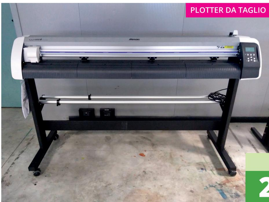
Plotter da taglio COME NUOVO, usato solo per demo showroom. Luce di taglio: 137cm, ampia capacità di taglio su una gamma di supporti molto vasta, permette la realizzazione di nuove applicazioni con un'alta velocità di lavorazione (fino a 70cm/s). Rilevamento in alta velocità dei crocini di registro, pressione di taglio fino a 500 gf, funzione di taglio passante che mantiene l'immagine in posizione dopo il taglio per adesivi e decalcomanie perfette!
