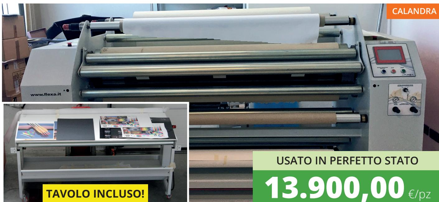
**Calandra con cilindro riscaldato a olio caldo in perfetto stato, attualmente in funzione.** Visibile dal cliente per prove dimostrative. Specifica per il trasferimento termico da carta sublimatica a tessuto e fissaggio di inchiostro stampato direttamente. Macchina compatta che garantisce uniformità e stabilità di temperatura per l'intero processo lavorativo e su tutta la larghezza del cilindro. **Tavolo frontale montato su ruote Incluso!**
