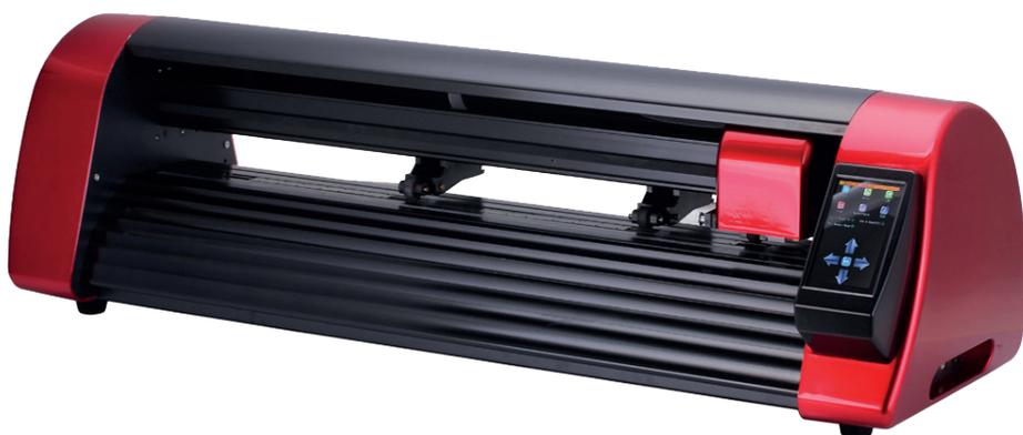
Plotter da taglio 610mm con rilevamento crocini automatico tramite fotocamera inclusa, display touch screen per la massima semplicità d'uso, Pressione di taglio da 50gf a **2000gf**, può tagliare anche film riflettenti. Connessione USB. Preciso, veloce, silenzioso e dal design funzionale questo plotter da taglio semplifica molto il lavoro di tutti gli stampatori di etichette, adesivi e altro con risultati sempre perfetti!
