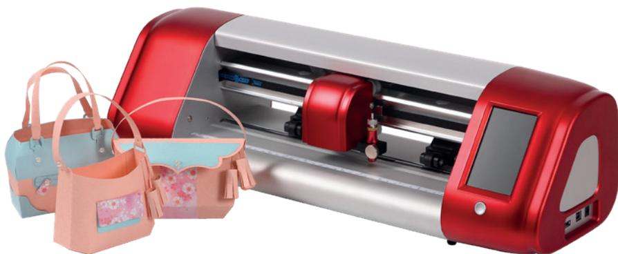
Plotter da taglio 720mm con rilevamento crocini automatico tramite fotocamera inclusa, display touch screen per la massima semplicità d'uso, Pressione di taglio da 50gf a **800gf**, può tagliare anche film riflettenti. Connessione USB. Preciso, veloce, silenzioso e dal design funzionale questo plotter da taglio semplifica molto il lavoro di tutti gli stampatori di etichette, adesivi e altro con risultati sempre perfetti!
